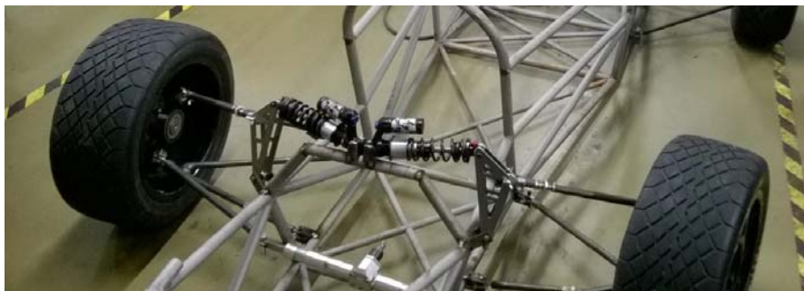
Fig. 5.15. Monopostul echipat cu sistemul de suspensie propus.
