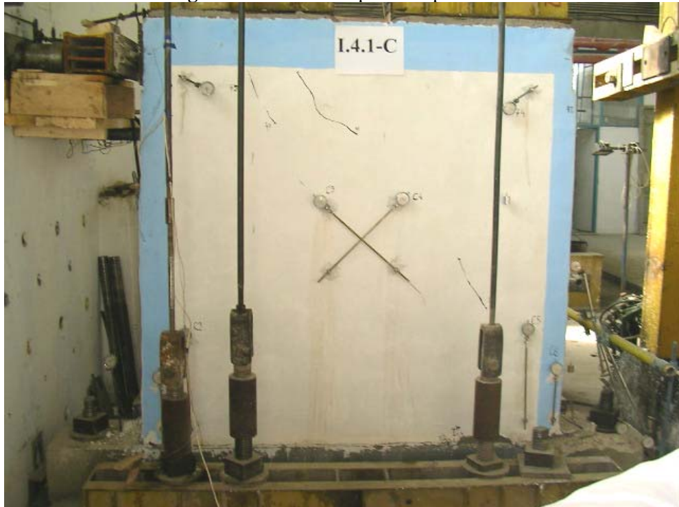
Fig. 3. Echiparea standului de încercare a elementului de zidărie consolidat
