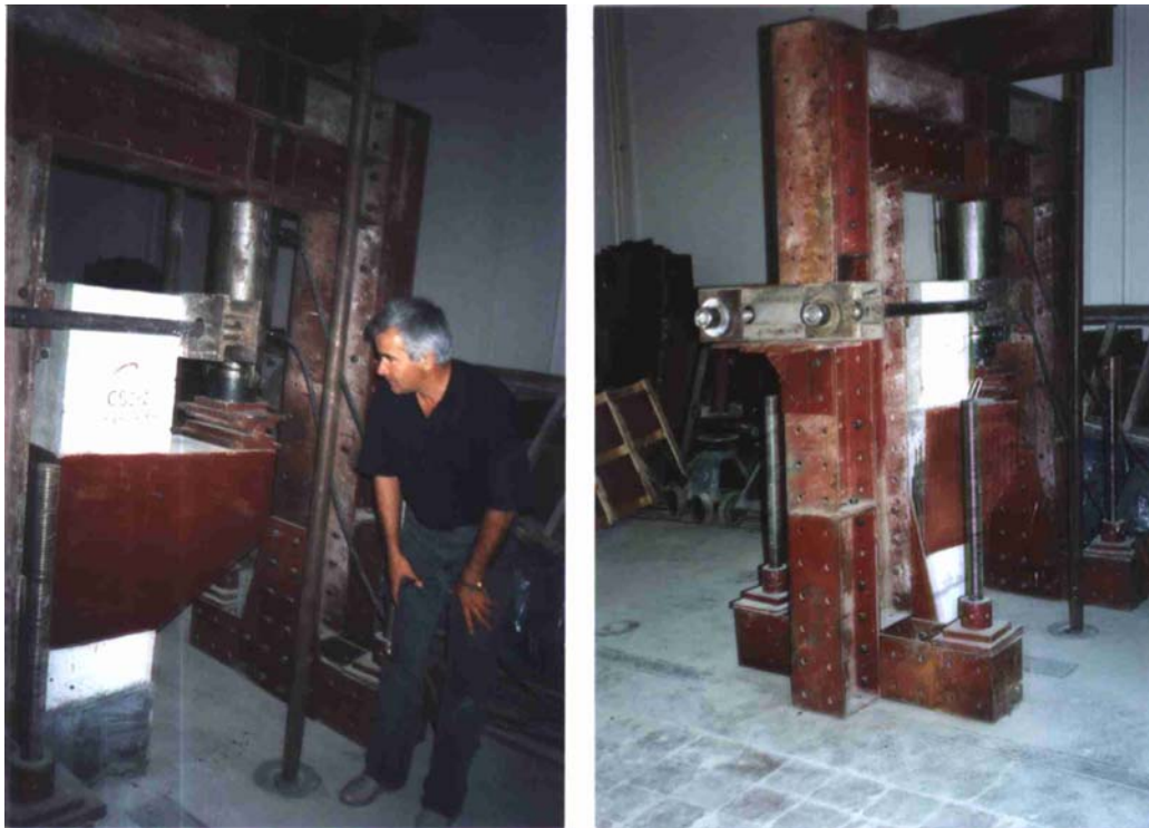
Fig. 10. Ansamblu experimental pregătit pentru încercare Modul de realizare a consolidării și executarea confecției metalice s-a făcut în concordanță cu datele și prescripțiile tehnice existente în literatura de specialități [3], [4], [5]. Detalii privind realizarea consolidării în varianta metalică sunt prezentate în fig. 11.
