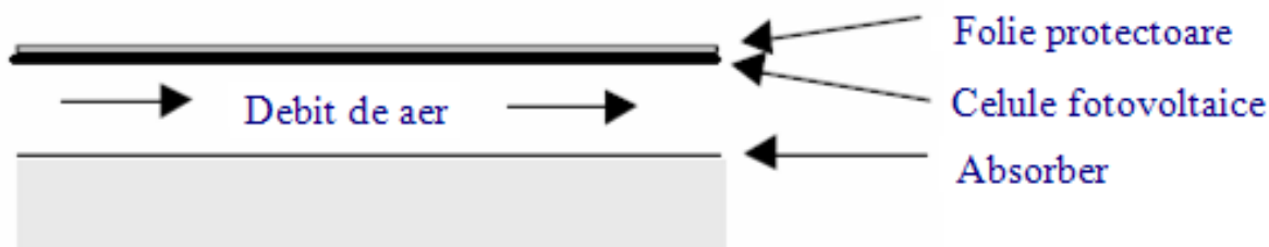
Fig.4. Exemplul unui colector PV/T cu aer
