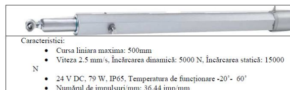
Figura 3.10. Tipul de actuator utilizat pentru realizarea mișcărilor (diurnă & elevație).
