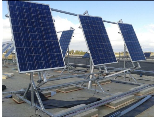
Figura 5.2. Modelul experimental al platformei PV cu sistem de orientare pseudo-azimutal.
