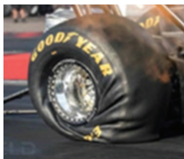
Fig. 4. Modificarea razei dinamice a roții unui dragster în timpul unui demaraj, cauzată în special de momentul motor aplicat
