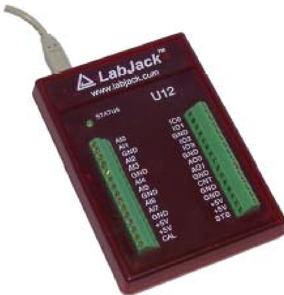
Fig. 3.6 Placa de achizitie de date LABJACK U12
