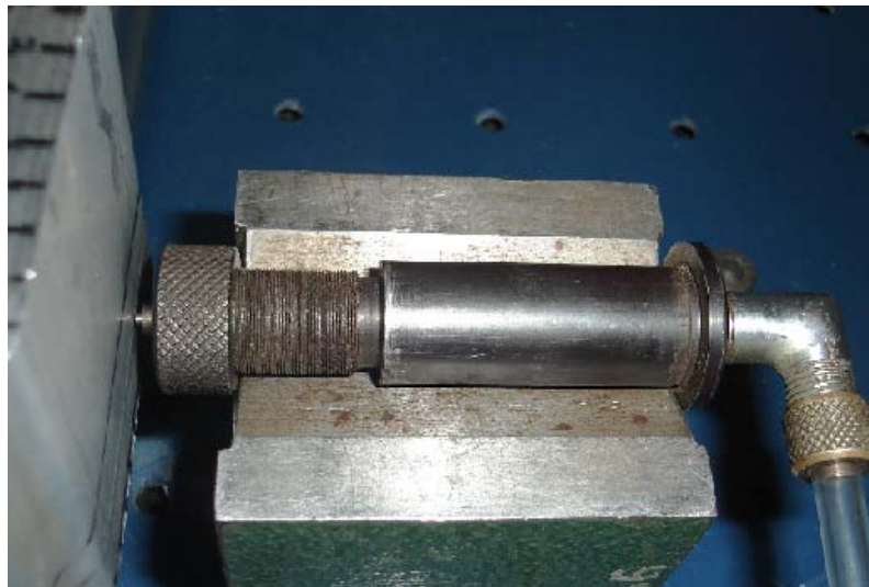
Fig. 1.7 Traductor de deplasare pneumatic, fara contact
