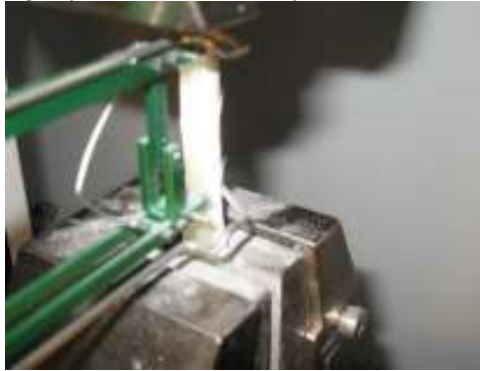
Figure 1 Epruveta prinsă în bacurile maşinii de încercat şi extensometrul prins pe epruvetă
