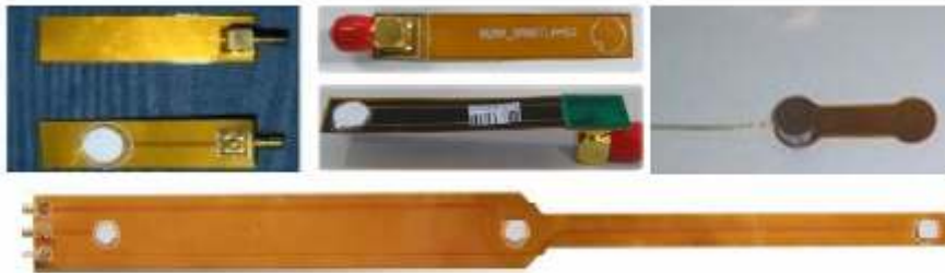
Fig. 3 A PZT sensor layer [4]
