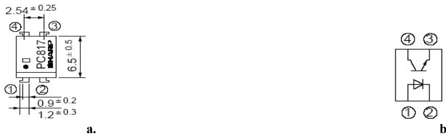
Figura 5.24 Circuitul optocuplor PC817 a - Capsula circuitului PC817; b - Diagrama conexiunilor interne a circuitului PC817.
