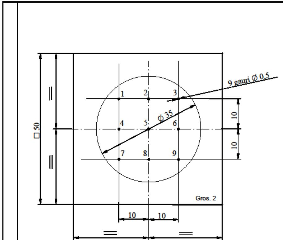
Fig. 4 Amplasarea orificiilor pe suprafata discului din G.B.F.
