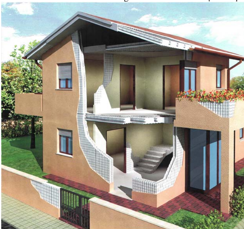
Fig. 2. Elemente structurale executate cu ajutorul panourilor din polistiren
