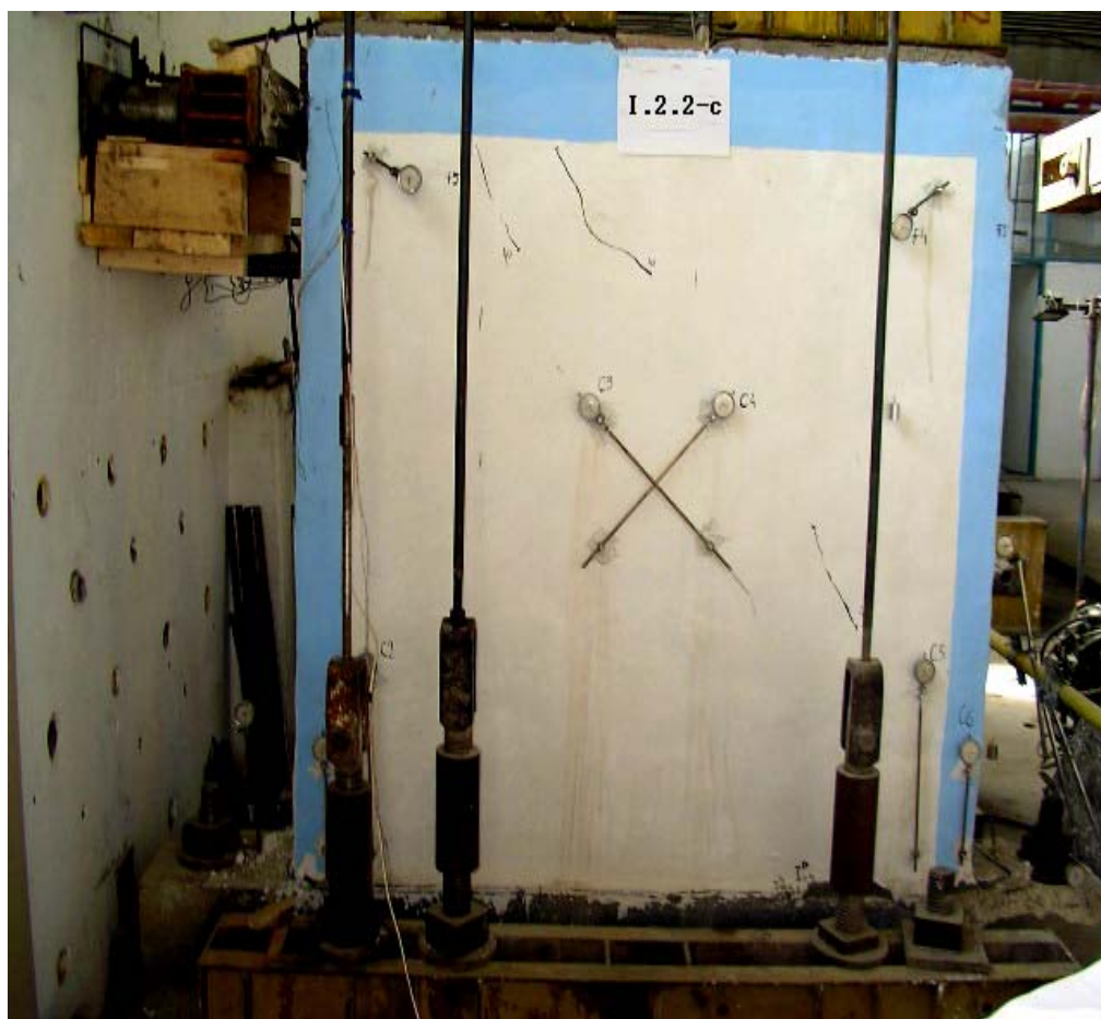
Fig. 7. Echiparea standului de incercare a elementului de zidărie consolidat
