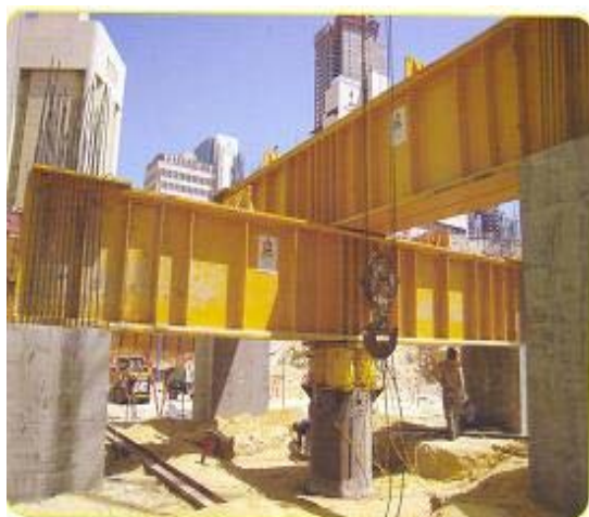
Fig.15-dispozitivul de încercare a piloților
