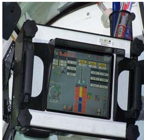
Fig.1-deplasarea utilajului pe pante mari Fig.2-ecranul monitorului la introducerea burghiului în pământ
