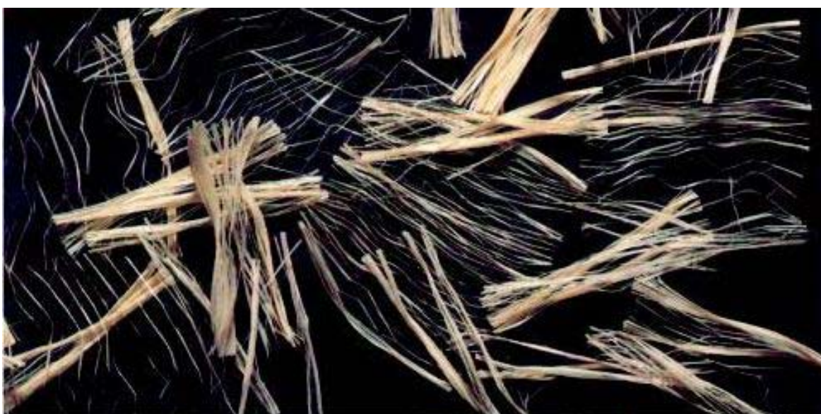
Fig.1 Fibra de polipropilena a) monofila b) fibrilată
